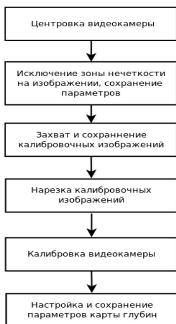
Рис. 5. Алгоритм работы этапа настройки системы
