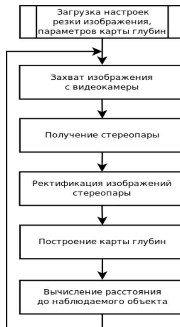
Рис. 6. Алгоритм работы этапа функционирования системы
