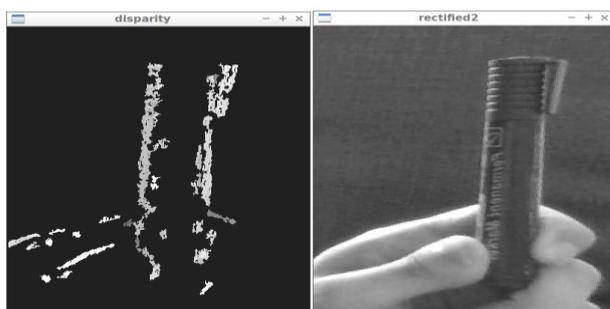
Рис. 8. Результат работы программной части системы (объект вблизи, слева — ректифицированное изображение, справа — карта глубин)
