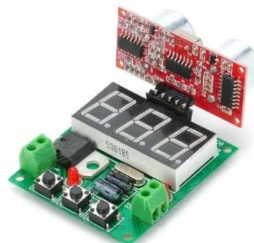
Рис. 16. Модуль *DYP-ME008* и ультразвуковой датчик *DYP-ME007*
