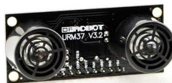
Рис. 14. Ультразвуковой дальномер *URM37*
