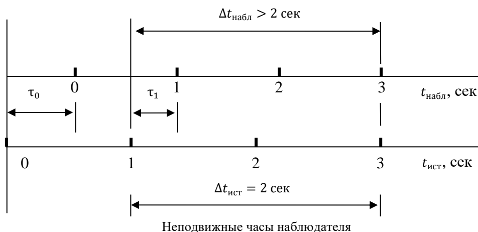
Рис. 3. Движение часов к наблюдателю. Движущиеся часы по наблюдениям идут быстрее неподвижных
