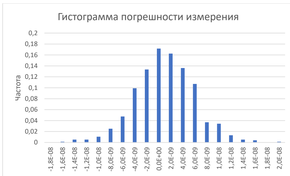
Рис. 9. Гистограмма погрешности измерения величины ускорения / замедления наблюдаемого хода времени движущихся часов
