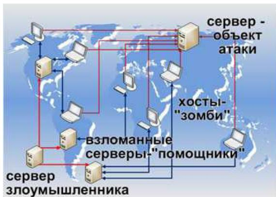
Рис. 1. Принципиальная схема распределенных сетевых атак
