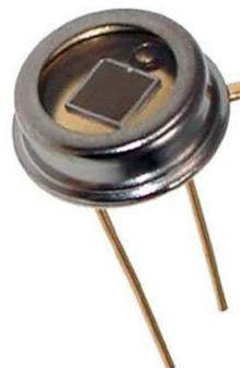
Приемник оптического излучения
