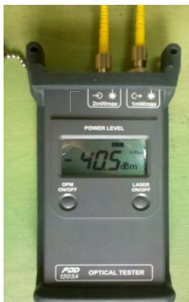
Рис.3. Тестер «FDD 1203A OPTICAL TESTER»
