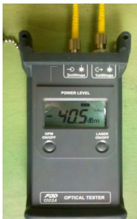
Рис.3. Тестер «FDD 1203A OPTICAL TESTER»
