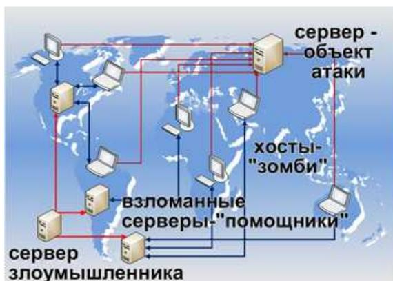
Рис. 1. Принципиальная схема распределенных сетевых атак
