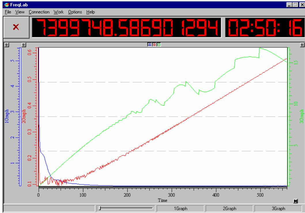
*Рис. 9.* Вид экрана компьютера при работе в режиме отображения функции Аллена
