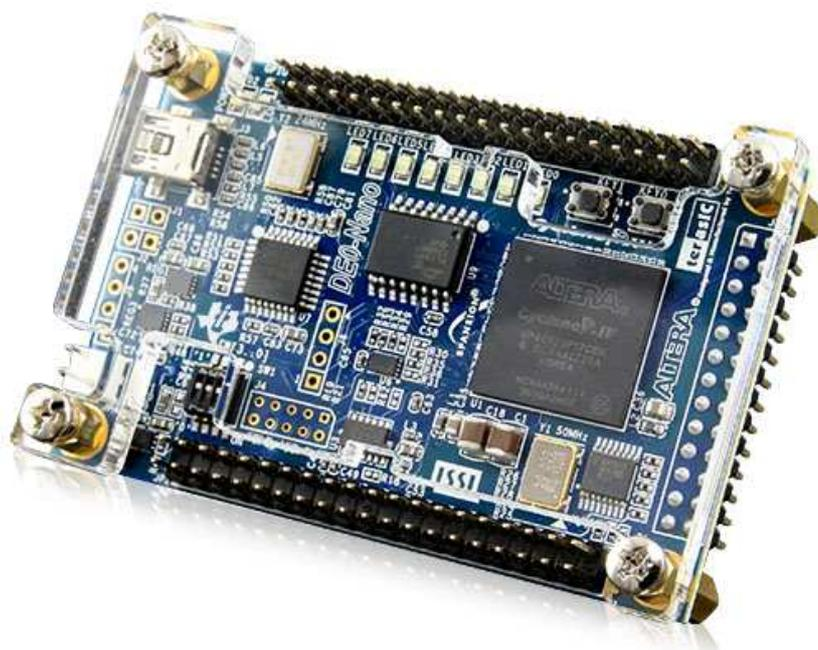
Рис. 12. Внешний вид отладочной платы, которая предполагается для использования в новом частотомере
