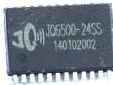
Рис. 1. Внешний вид микросхемы *JQ6500-24SS*
