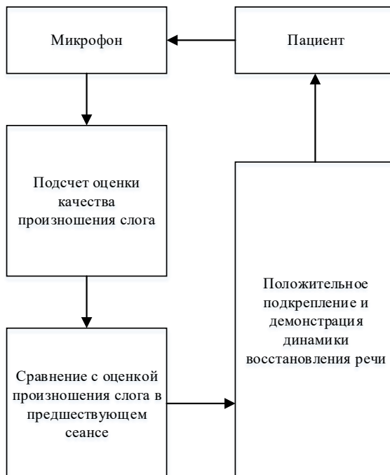
Рисунок. Функциональная схема сеанса оценки качества произношения слогов с применением технологии БОС
